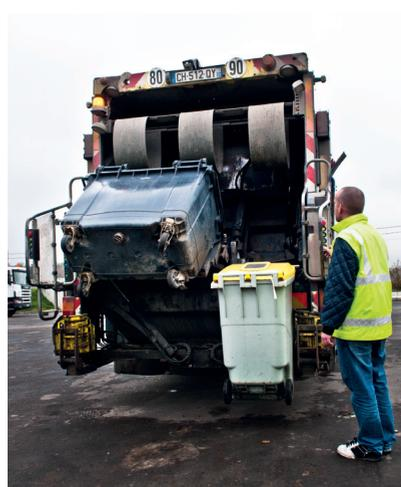
C'est effectivement le même camion qui collecte les deux flux mais celui-ci est équipé de deux compartiments bien séparés : à gauche les OM, à droite le tri ! De retour à Chanceaux, le camion déversera le flux jaune dans le centre de tri et les ordures ménagères dans les casiers d'enfouissement.
